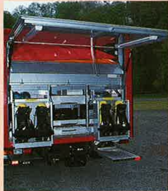
Im Heck sind vier Preßlufttmer in ausklappbaren Schubladen verstaut.
