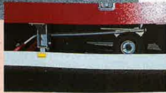
Jeder Zentimeter Platz ist ausgenutzt: eine Sackkarre ist am Boden untergebracht und wird bei Bedarf herausgeholt.
