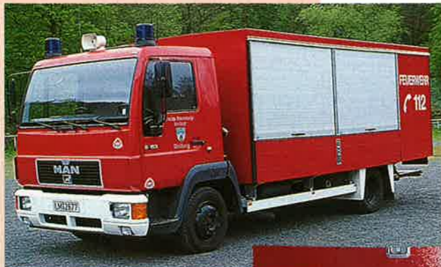
Gerätewagen Gefahrgut auf MAN 8.153, der Aufbau stammt von Heines in Wuppertal.
