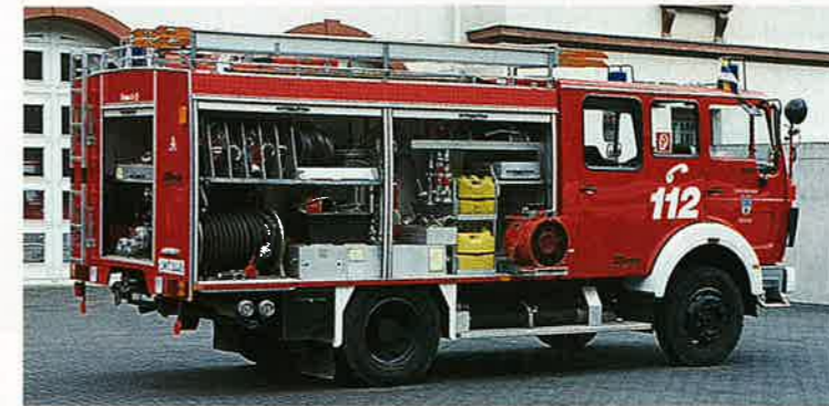
TLF 16/25, MB 1222 / Metz mit Be- und Entlüftungsgert, Tank mit 2500 Liter Wasser, Rollgliss und Wasserring-Monitor.
