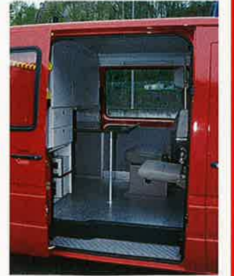
In der Mitte des Fahrzeugs befindet sich ein Analyse- und Arbeitsplatz.
