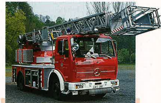
DLK 23-12 von Metz auf MB 1419. Fluoreszierender Sicherheitsstreifen am Heck des Fahrzeuges. Die DLK wurde mit Schleuderketten nachgerüstet.
