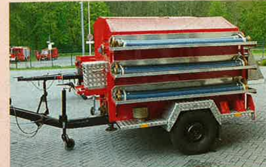
Ein Ölsanimat auf Anhänger. Damit kann ein Öl-Wasser-Gemisch getrennt werden.
