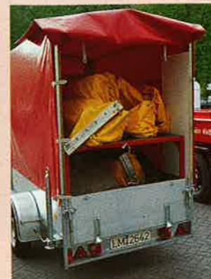
Der Anhänger Ölsperre/Ölschlengel. Auf zwei Ebenen kann das Material gelagert werden.
