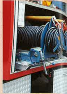
Zusätzlich hat die Feuerwehr auf der rechten Seite einen Schraubstock angebracht.
