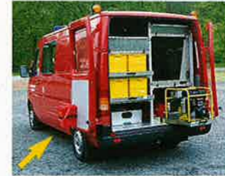
Im Heck ist ein 8,5-kVA-Stromerzeuger von Bosch eingeschoben. An der linken Hecktür hängt ein kleiner Mülleimer (Pfeil). „Es gab nie einen Platz für Abfälle, sie landeten meist irgendwo im Innenraum, das ist jetzt vorbei“, lobt Georg Hauch das kleine, nützliche Detail.
